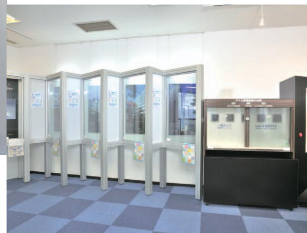
透明感を保ち、遮熱性能と断熱性能を向上させたビル用Low-E複層ガラス「ヘアマルチLow-E」。結露の発生の違いを実演しています。(写真右)
