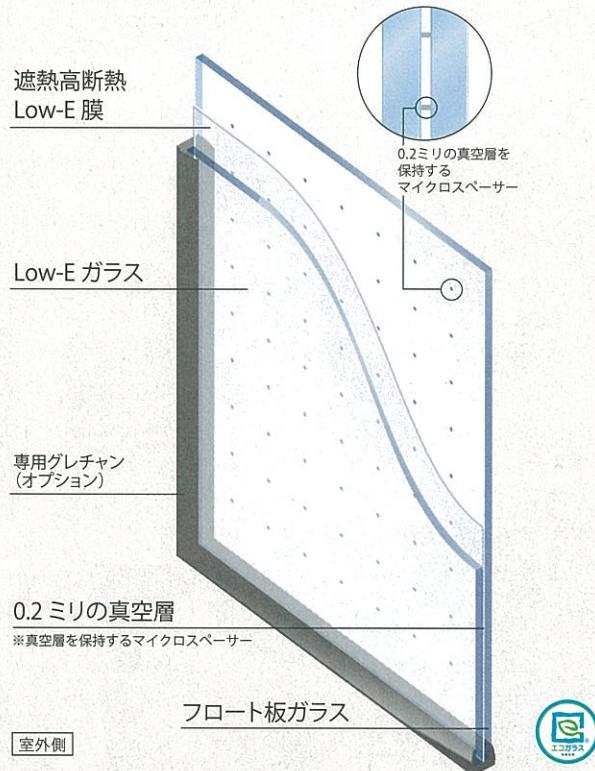
スペーシア クールは、ガラスとガラスの間が空気ではなく、真空になっているうえ、室外側のガラスにはLow-E膜がコーティングされているので、窓からの熱の出入りを大幅に遮断する
