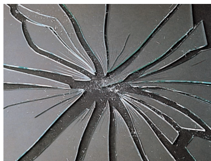
一般の板ガラスの破片
