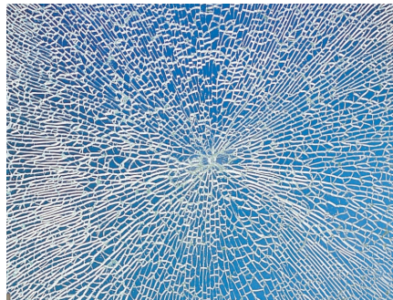
強化ガラスの破損状況
