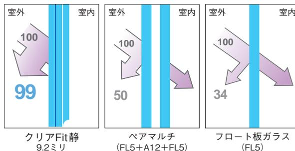
※太陽からの光には紫外線・可視光線・赤外線が含まれます。紫外線を大幅にカットするガラスも可視光線は一般の板ガラスと同様に透過します。材料の変色・褪色や人体の日焼けは、紫外線以外にも可視光線によって起こる場合がありますのでご注意ください。また太陽光以外、例えば蛍光灯など一般照明にも紫外線が含まれている場合がありますので、環境設計にはご注意ください。
