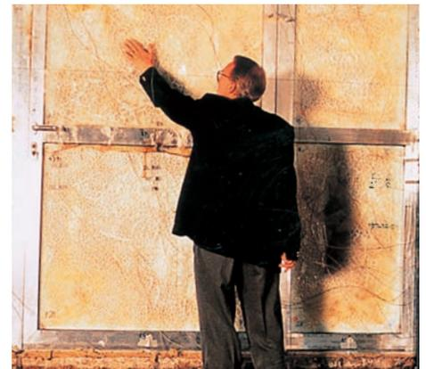
防火テスト中：パイロストップの非加熱面の温度は手でも触れられる程度の温度にしか上昇しません
