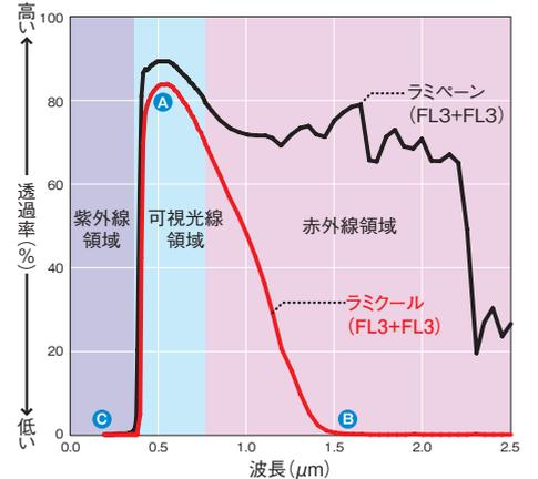
ラミクールはラミペーンと同等レベルに可視光線を透過させながら(図中A)、ラミペーンに比べ赤外線をカットするのが特長です(図中B)。そのため、室内は明るいまま、太陽熱を遮り窓辺のジリジリ感をやわらげます。さらに紫外線を大幅にカットしますので、家具やカーペットの変色・褪色防止にも効果的です(図中C)。
