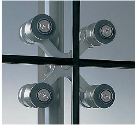
フィッティングナットとキャップナットを2つ持ったシステムで、支持部材へはこれらのナットにはさまれたスプリングプレートで取り付けます。PILKINGTON社の開発した原型を耐震性能の向上など日本の実状に合わせたもので採用例の多いシステムです。
