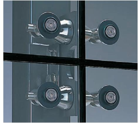
皿ボルトを一つのフィッティングナットにねじ込むシステムで、支持部材から出たスプリングロッドに載せるだけのシンプルな構成です。DPG構法特有のシンプルな形状をつくることができます。
