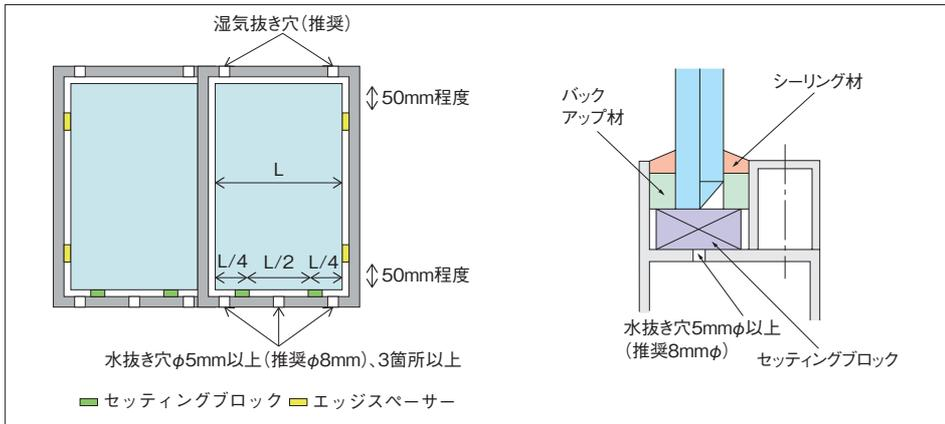
1. ガラス小口が長期間、水に接していると真空ガラスの封着部の劣化が早まりますので、サッシ溝内に入った水を速やかに排出するため、サッシ下枠に直径φ5mm以上(推奨直径φ8mm)の水抜き穴を3か所以上設けてください。
