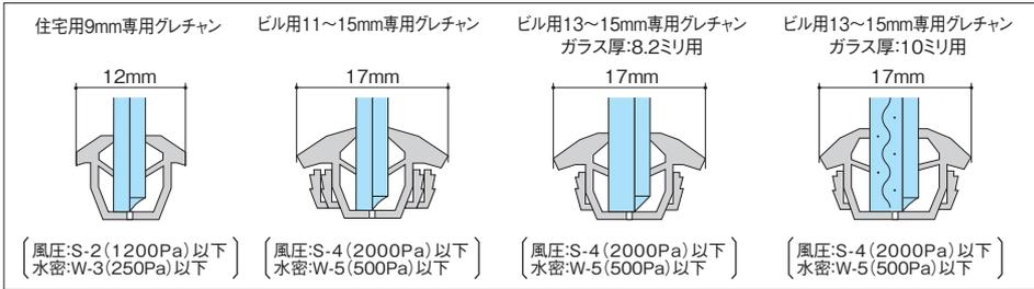
1. サッシの溝幅および必要な耐風圧性能、水密性能に適合した専用グレチャンを使用してください。専用グレチャンが使用できない場合はシーリング施工を行ってください。
