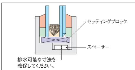
10. 合わせ真空ガラス(「スペーシア静」など)のクリアランス、かかり代などの寸法は、JASS-17 (日本建築学会・建築工事標準仕様書17・ガラス工事)に規定された合わせガラスの寸法を最小値としてください。真空ガラスはその総厚と同じ単板ガラスとして判断してください。P.162参照
