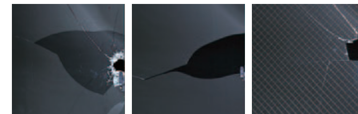
セキュオペア30 一枚ガラス 網入板ガラス ※ 破損状況比較は弊社試験結果の一例です。ガラスを破壊する人の体力、技術等によって破損状況は異なりますので、その防犯性能を保証するものではありません。
