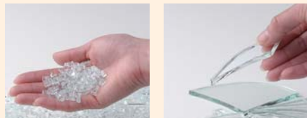
スクールタフライトの破損 フロート板ガラスの破損
