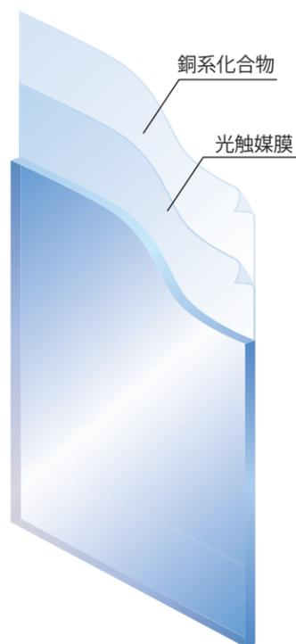
ウイルスクリーン®はガラス面に付着するウイルスを蛍光灯やLED照明などの可視光によって99%以上低減します。透明性は通常のフロート板ガラスとほとんど変わらず、クリアな視界を保ちます。
