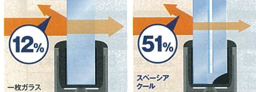
断熱層でも止めることが困難な日射熱を、特殊な金属膜(Low-E膜)で遮る「スペーシアクール」。一枚ガラスの4倍以上*1の日射熱をカット *数字が大きいほど遮熱性能に優れている
