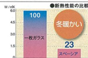
窓から失われる熱の量を、一枚ガラスを100%として比較した場合、スペーシアなら約23%しか熱を逃がないので、寒い冬も部屋の暖かさを保ち、結露の発生を抑えることができる。
