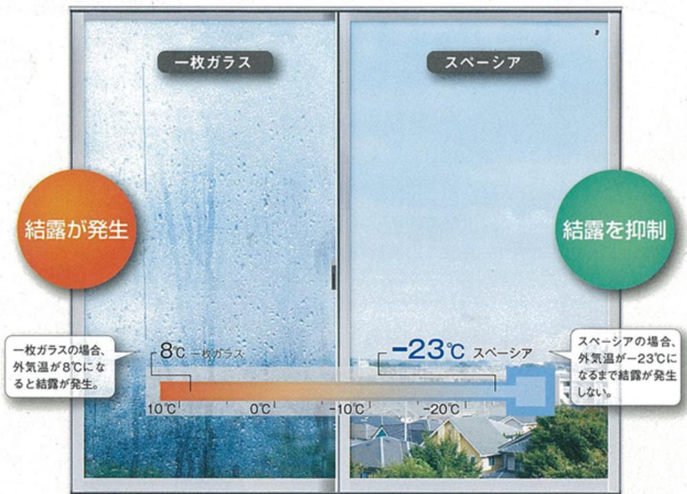
※算出条件／室内温度20°C、室内相対湿度60%、室内自然対流、戸外風速3.5m/sの場合(同社調べ)。
