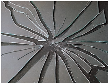
一般の板ガラスの破片
