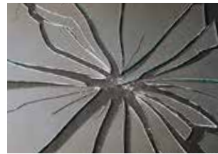
一般の板ガラスの破片
