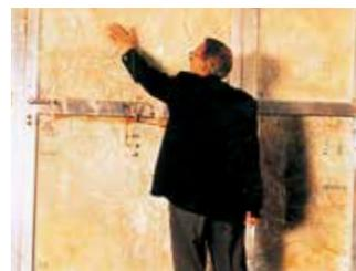
防火テスト中：パイロストップの非加熱面の温度は手でも触れられる程度の温度にしか上昇しません
