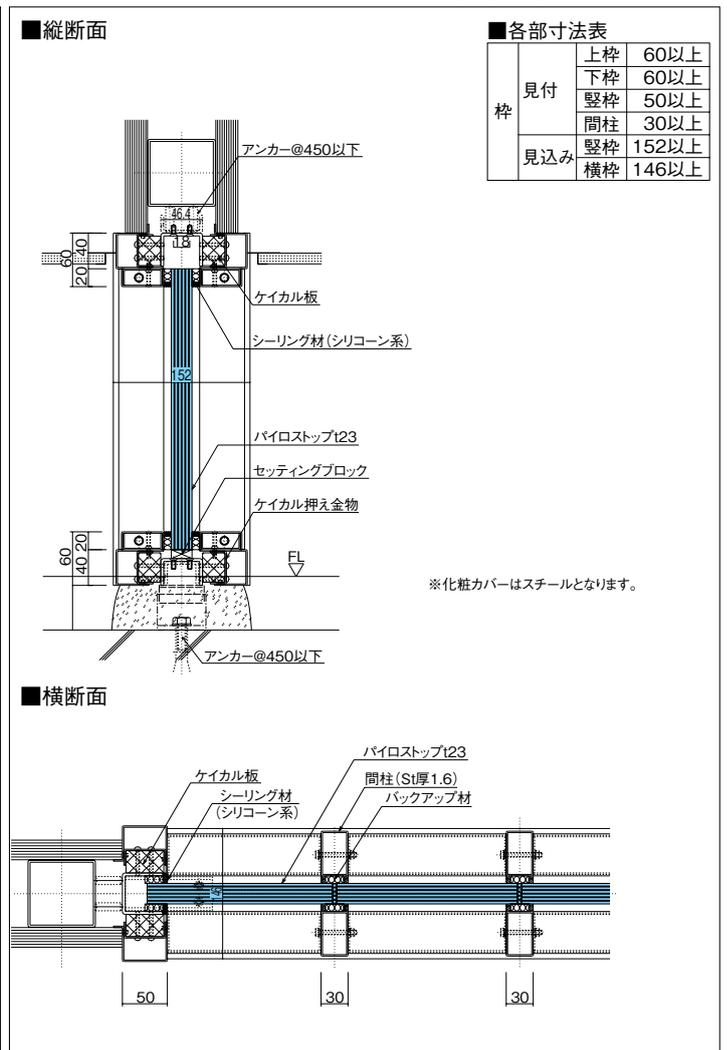
●1時間耐火間仕切壁(段窓タイプ) パイロストップウォール:特殊なフレームと一体で認定を取得しています。
