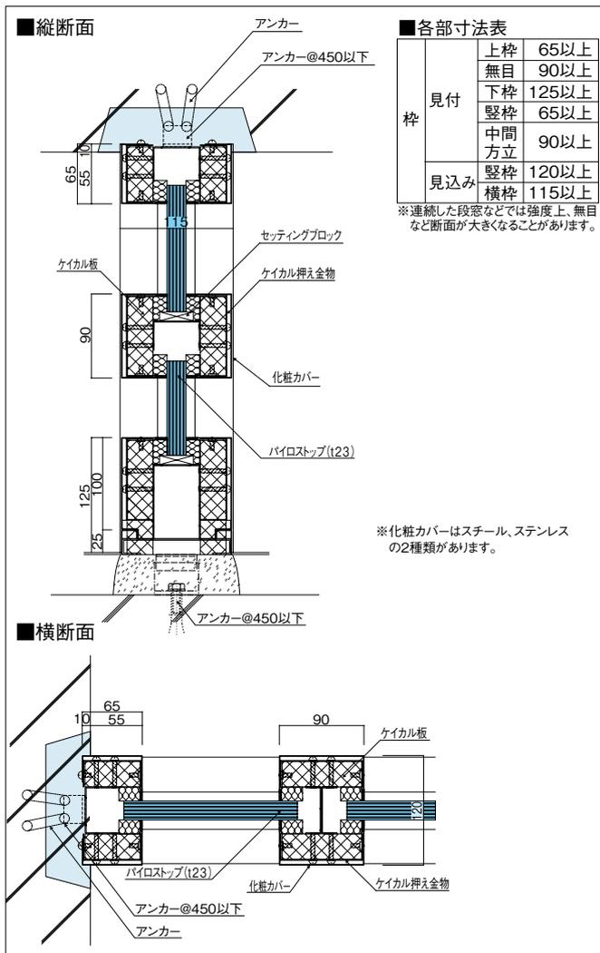
●パイロストップウォール(スリムタイプ)断面詳細図(参考図)
