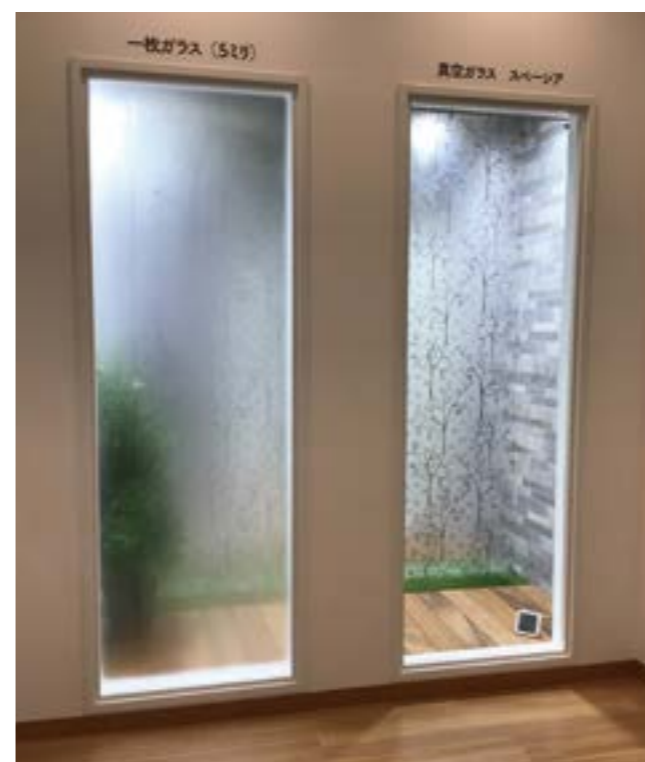
※ガラス奥側(室外側想定)は2°C、ガラス内側(室内側)は20°Cの設定です。
