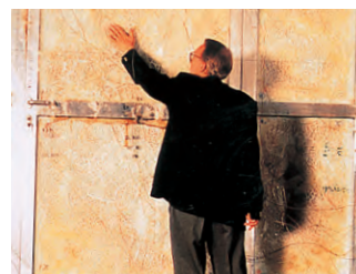
防火テスト中：パイロストップの非加熱面の温度は手でも触られる程度の温度にしか上昇しません
