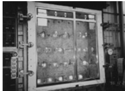
耐火間仕切壁 パイロストップウォール試験状況 ガラス品種:パイロストップ23ミリ(標準枠タイプ) 認定No.:FP060NP-9007
