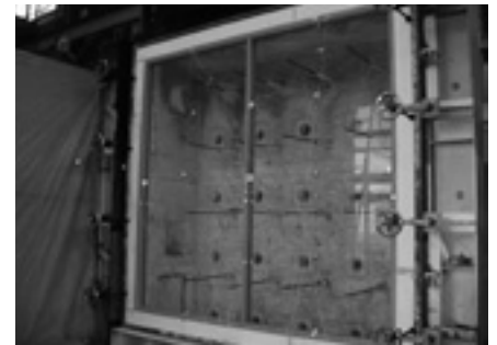
耐火間仕切壁 パイロストップウォール試験状況 ガラス品種:パイロストップ23ミリ(スリム枠タイプ) 認定No.:FP060NP-0343
