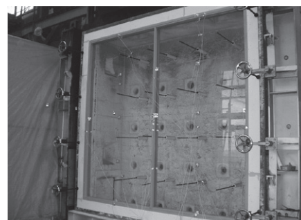
耐火間仕切壁 パイロストップウォール試験状況 ガラス品種:パイロストップ23ミリ(スリム枠タイプ) 認定No.:FP060NP-0343
