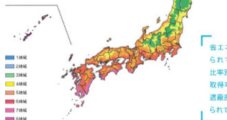
省エネルギー基準では、仕様基準が設けられており、地域別・住宅種別・開口部比率別に、窓の熱貫流率、ガラスの日射熱取得率とそれに見合った併用すべき日射遮蔽部材(付属部材・庇・軒)の種類が定められています。
