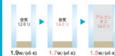
※ガラス構成は「Low-Eガラス32リットル+中空層+フロート板ガラス32リットル」
