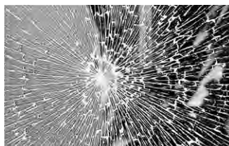
曲げ破壊例 加撃物：ゴム球1.3kg ガラス：フロート板ガラス5ミリ (飛散防止フィルム貼り)
