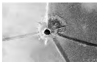
ヘルツ破壊例 加撃物：鋼球50g ガラス：フロート板ガラス5ミリ
