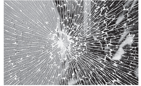
曲げ破壊例 加撃物：ゴム球1.3kg ガラス：フロート板ガラス5ミリ (飛散防止フィルム貼り)
